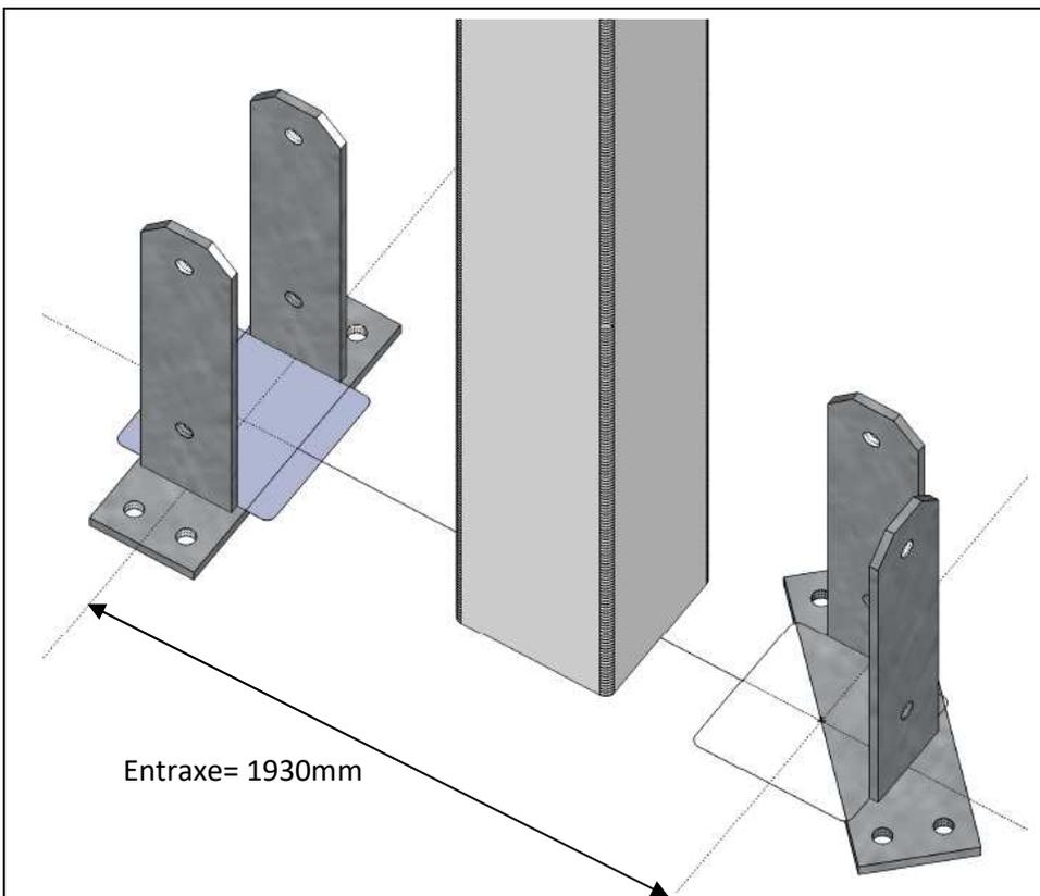
Angle de clôture sur dalle ou muret béton.
